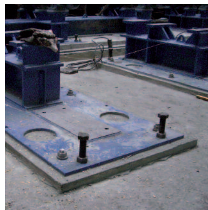
PCI Repaflow® vytváří bezešvé, beztrhlinové a bezdutinové spojení, které umožňuje klidný chod a přesnou práci stroje a snižuje jeho opotřebení.
